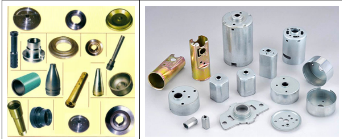
Şekil 87. Otomotiv endüstrisi için dövme (solda) 101 ve damgalama/baskılama (sağda) 102 ile oluşturulmuş parçalar
